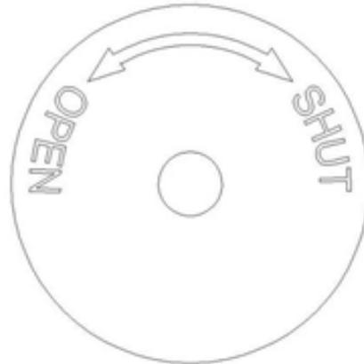
**Bild 2:** Handradanzeiger für Öffnungs- und Schließzeichen
